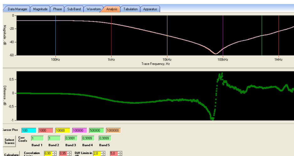
Obr. 1. Názorný príklad porovnania dvoch priebehov pomocou Cross korelačných koeficientov pre meranie A-N rovnakého transformátora.
