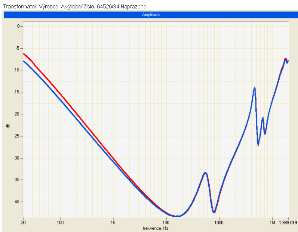
Obr. 1. Meranie SFRA charakteristík transformátora Yyn, 3kVA, metodika naprázdno, fáza A – N, červený priebeh - prvotné meranie ( B = 0,04319 mT), modrý priebeh – meranie po prevádzke transformátora ( B = 0,36 mT).
